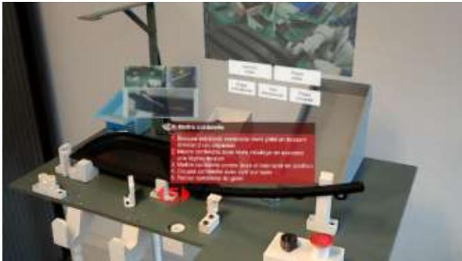
Reproduction du poste de travail sur la plateforme avec instructions d'assemblage superposées en réalité augmentée.
